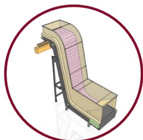
La bande du tapis élévateur dispose de cavités permettant de recevoir les bouchons seulement par leur partie sphérique. En partie supérieur les bouchons sont récupérés en position et déplacés par un convoyeur à air.
