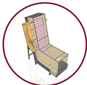
Les bouchons sont réceptionnés dans une trémie de stockage puis repris par un tapis élévateur équipé de tasseaux dont l'espacement et les dimensions permettent de faire la sélection: les bouchons qui n'ont pas la position souhaitée retombent dans la trémie et seuls les bouchons bien positionnés se retrouvent en haut de l'élévateur. Ils sont alors déviés, à l'aide de soufflettes ou de déflecteurs mécaniques, vers une rampe puis vers un couloir d'accumulation.
